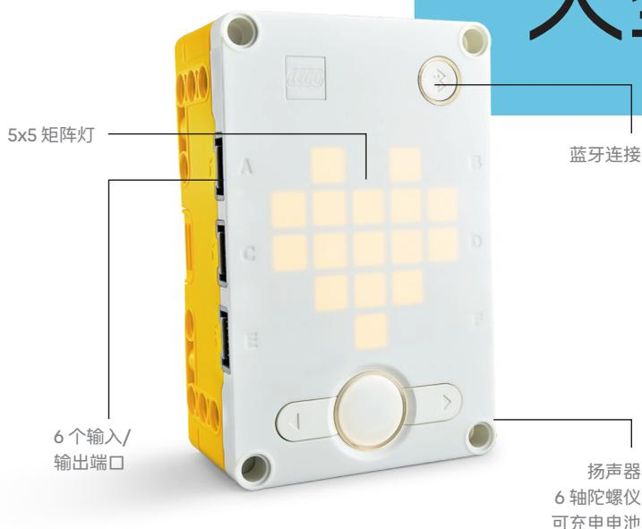
LEGO® Education SPIKE™ Prime 科创套装系统的核心是可编程式大型智能集线器。SPIKE Prime 科创套装还包括高精度电机和传感器，可与色彩丰富的乐高积木颗粒组合使用，学生们可以设计和搭建有趣的机器人、动态设备及其他交互式模型。
